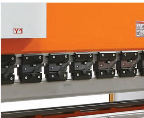
■ Stempelhalterungen der Bauart „Promecam“ sind manuell einfach einzusetzen und wieder abzunehmen (S)
