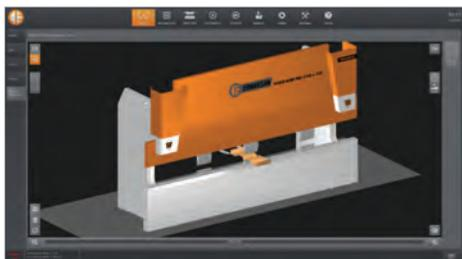
■ Die Anlage kann das Teil in 3D anzeigen und auch die Biegungsreihenfolge berechnen
