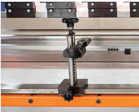
■ Sonderangefertigte, klappbare Fingerblocks Hinteranschlag (S)
