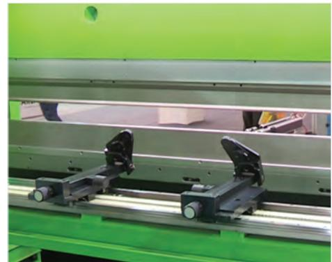
■ 4 Achsen (X, R, Z1, Z2) Servomotor mit Hinteranschlag, der Hinteranschlag kann mit einer Positioniergenauigkeit von 0,05 mm je nach gewünschter Geometrie eingestellt werden (S)
