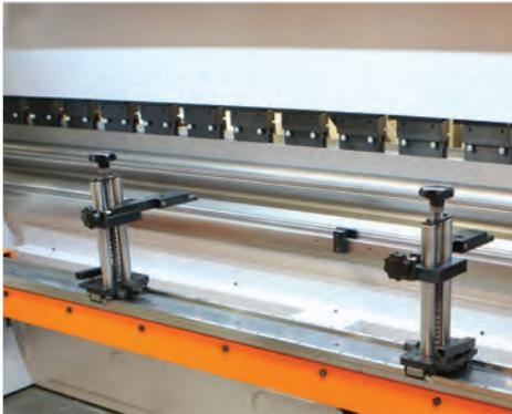
■ Das Power-Bend Pro Standard-Rückanschlagssystem besitzt eine X-Achse mit Antrieb und eine manuell bewegliche R-Achse (S)
