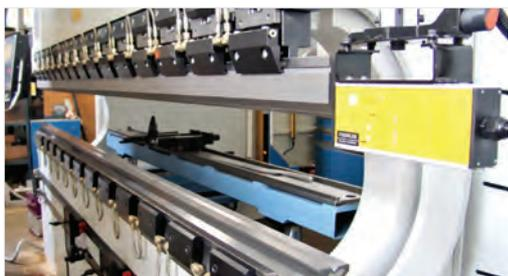
■ Stempelhalterungssystem mit einfacher Spannung zusammen mit den Werkzeugen (O)
