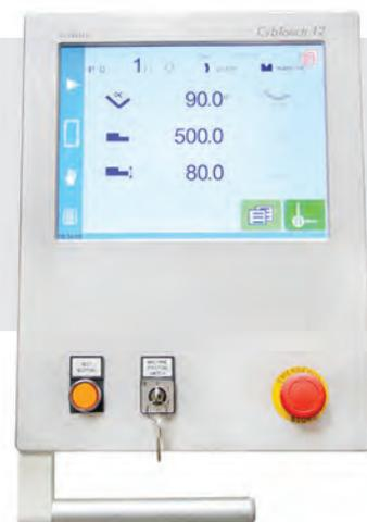
Der Bediener wird ständig durch automatische Funktionen, wie eine interaktive Touchscreen-Softwareoberfläche mit großen Tasten, einem 2D-Grafik-Display, Online-Unterstützung etc. geleitet.
