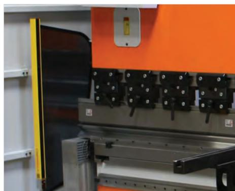
■ Körperschutz-Lichtschranke gemäß den CE-Normen, die einen sicheren Betrieb gewährleisten (S)
