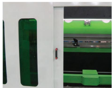
■ Maximale Sicherheit dank des hinteren Gleitkäfigs und Schalter-Sicherheitssystems Anhand der Fenster kann das Innere der Anlage kontrolliert werden (S)
