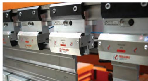
■ Das pneumatische Werkzeughalterungssystem spannt mit Hilfe von Druckluft automatisch die Werkzeuge und leitet diese zum eigenständigen zentrieren. Eine ausgezeichnete Lösung zum Verkürzen der Set-up Zeit bei Abkantpressen mit Automation (O)
