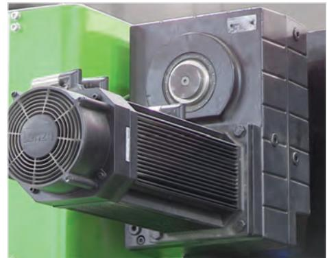
■ Hocheffiziente Synchron-AC-Servomotoren bewegen den oberen Balken (S)
